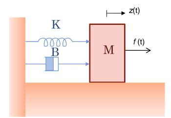
$$x(t) = \begin{bmatrix} \int z dt \\ z \\ \dot{z} \end{bmatrix} \qquad A = \begin{bmatrix} 0 & 1 & 0 \\ 0 & 0 & 1 \\ 0 & -\frac{k}{m} & -\frac{b}{m} \end{bmatrix}, B = \begin{bmatrix} 0 \\ 0 \\ \frac{1}{m} \end{bmatrix}$$
